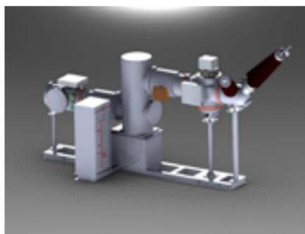
ZF-145(L)/T3150-40 将断路器、隔离开关、接地开关、电流互感器、电压互感器、避雷器、母线等集合封闭在金属壳体之内成为一个整体，具有结构紧凑、占地面积小、可靠性高、运行维护工作量小、检修方便灵活等优点。所有的功能模块连接尺寸都相同，使得各种模块能够任意组合，可以满足各种变电站的设计和布置要求。
